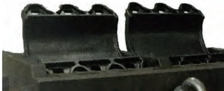
Ausgangsmaterial sind hier Gusschalen und Rohkautschukblöcke. Diese werden zunächst mit Haftvermittler behandelt um eine optimale Verbindung zu erreichen.
