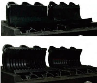
In Formkästen unter hydraulischen Rahmenpressen vulkanisieren die beiden Komponenten bei mind. 160°C unter einem Druck von bis zu 300 bar. Dabei erhalten auch die Dichtungen ihr Profil passend für den Rohrdurchmesserbereich. Modernste Steuerungstechnik mit Fehlermeldesystemen und Notaggregaten für Hydraulik und Pneumatik gewährleisten einen störungsfreien Ablauf und gleichbleibende Qualität.
